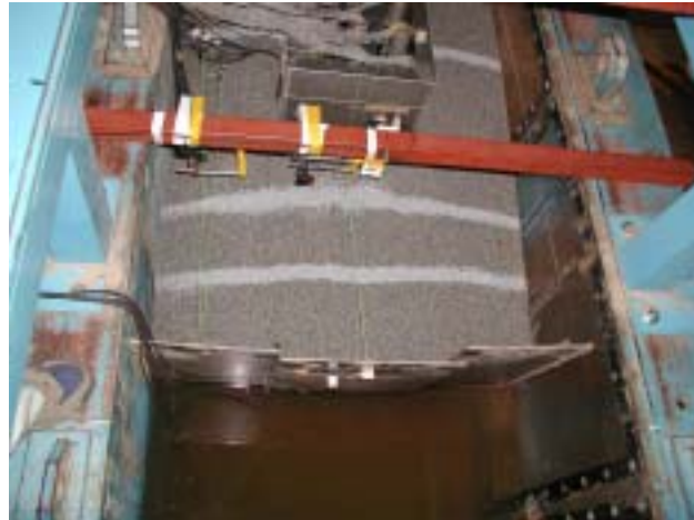
写真 4 3分割した矢板と地盤表面の変形状況 (Case1-2)
