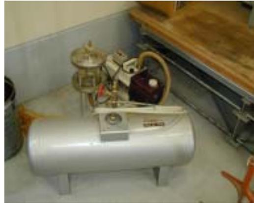
写真3 排水試験用治具
