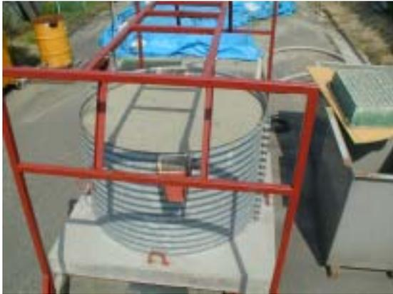
写真2 排水実験用土槽
