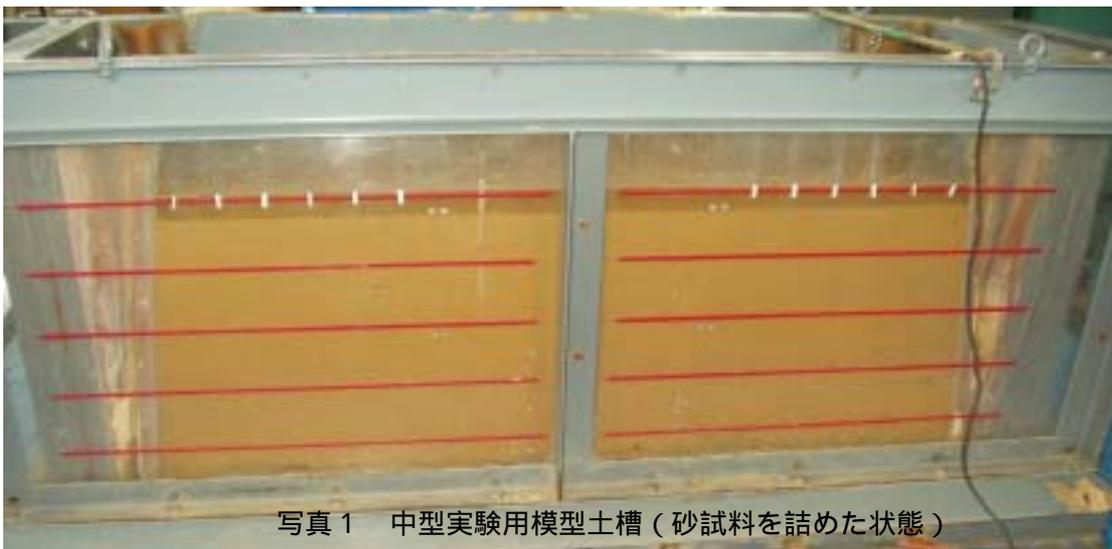
写真1 中型実験用模型土槽(砂試料を詰めた状態)
