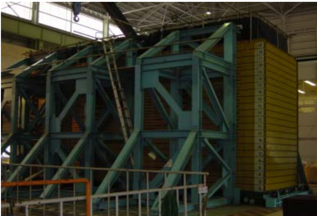
写真 1 大型せん断土槽
