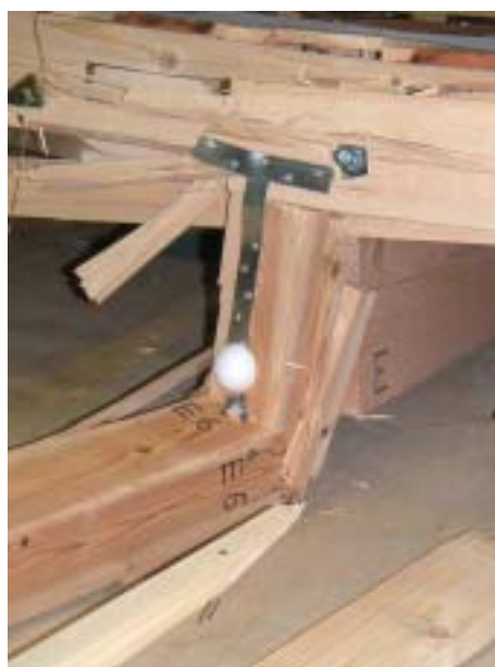
(3)柱頭の曲げ破壊
