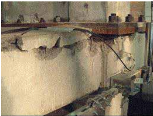
図10 最終破壊状況 (基礎固定型：Frame A)
