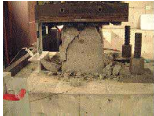
図11 最終破壊状況 (基礎浮き上がり型：Frame B)
