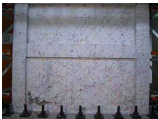
写真 6 部材角 1/100 終了時（試験体 A）
