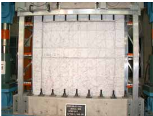
写真 8 部材角 1/100 終了時（試験体 B）
