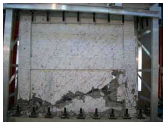
写真 7 最終破壊状況（試験体 A）
