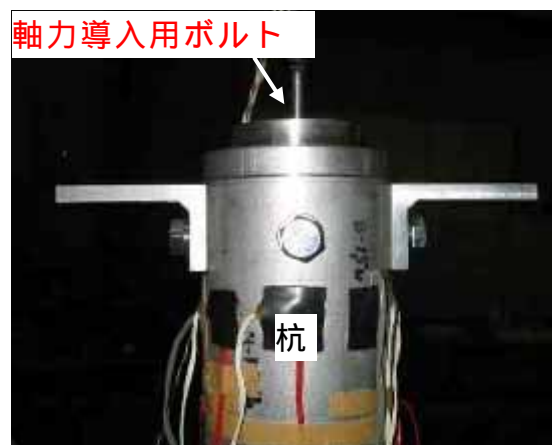
写真4 杭頭部（半剛接合試験体）
