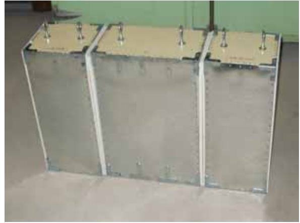
図3 ケーソン護岸模型
