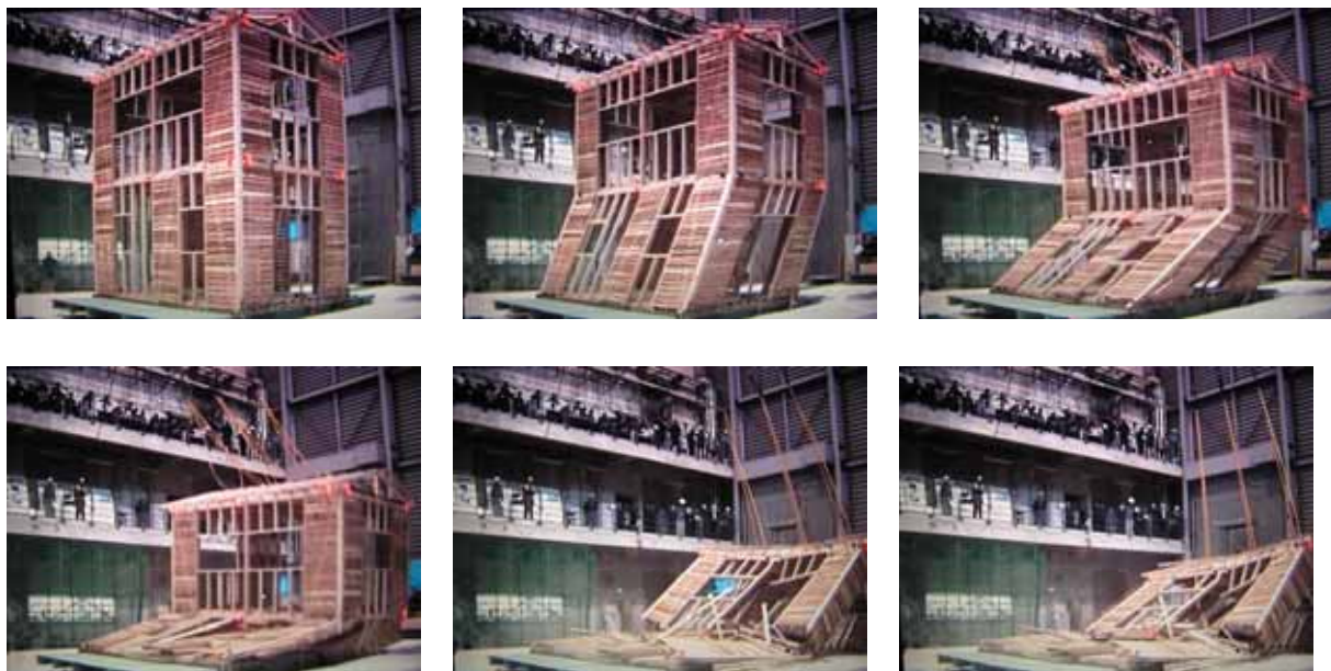
写真 1 2) No.6 試験体倒壊過程（北東面）
