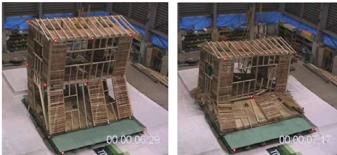
写真 1 1) No.6 試験体倒壊開始 終了
