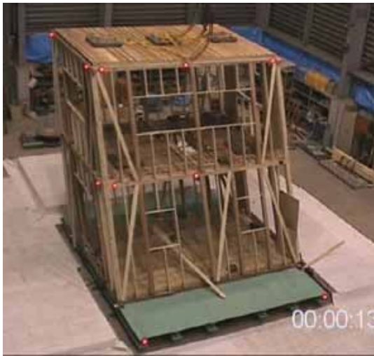
写真3 1) No.8 試験体倒壊開始 終了
