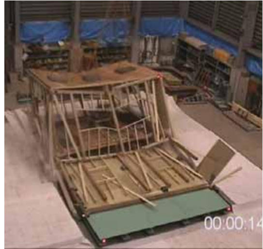
写真3 1) No.8 試験体倒壊開始 終了
