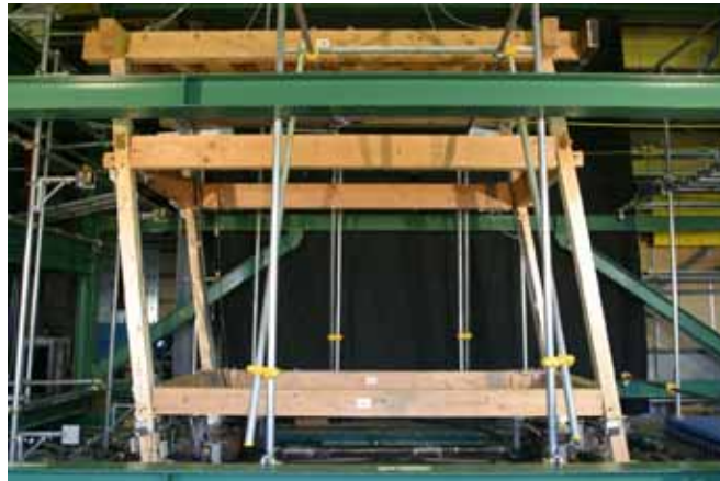
写真 3 大変形時の様子(立体足固試験体)
