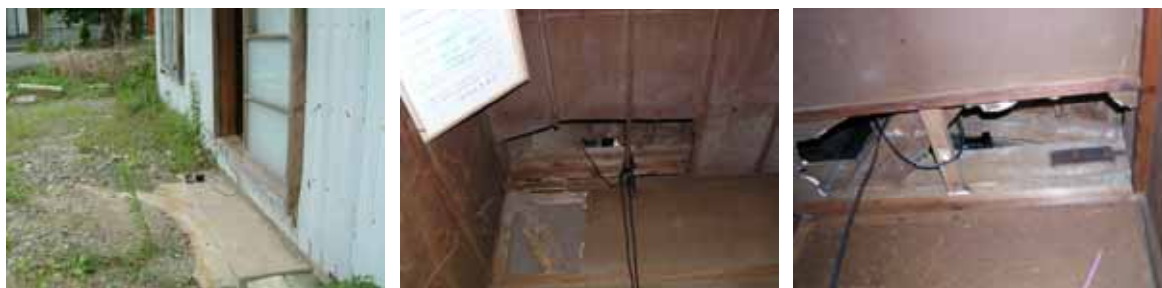
写真3 サervo型速度計の設置例
