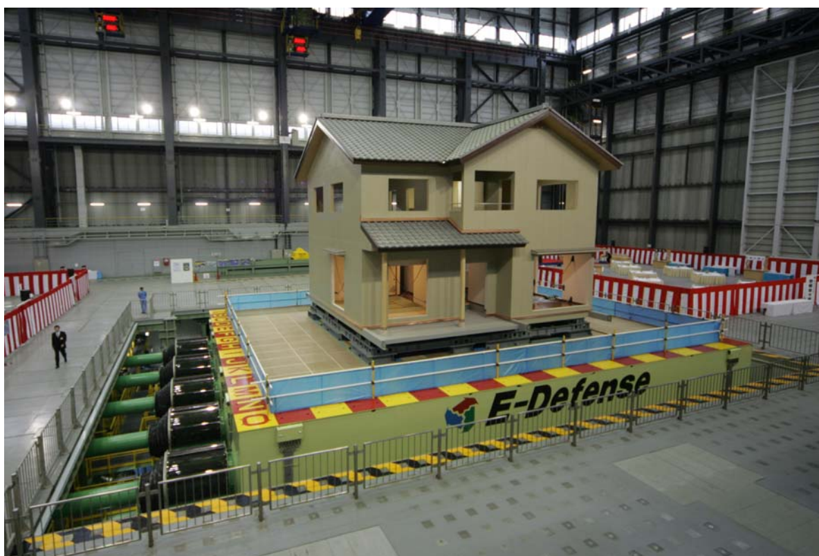
Eーディフェンス披露式・木造試験体の加振デモンストレーション (2005. 1. 15 : 阪神淡路大震災の時に神戸海洋気象台で記録された地震波で加振されました)
