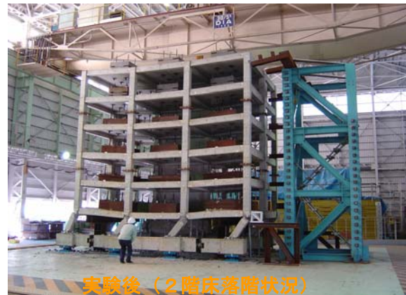
6層耐震壁フレーム構造の振動台実験
