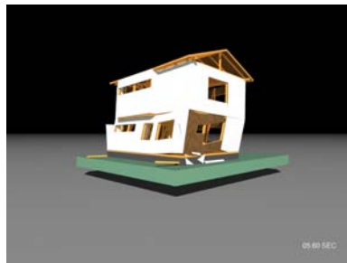
既存住宅の倒壊応答解析結果
