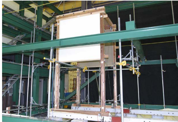
伝統構法木造軸組の土塗り小壁の振動台実験
