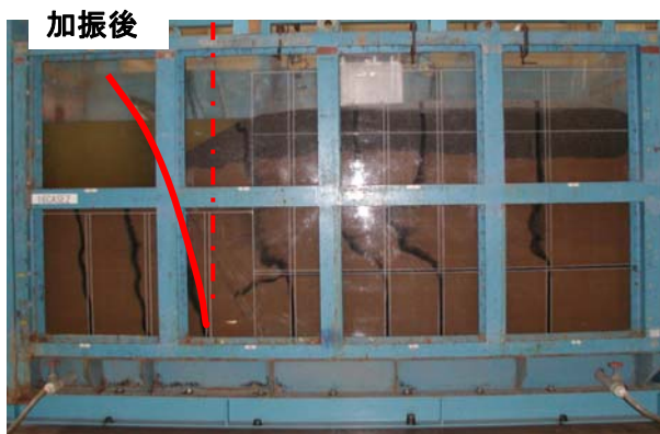
矢板式護岸の振動台実験とシミュレーション解析
