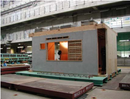
再現構面試験体の振動台実験
