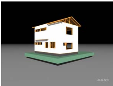
再現構面試験体の振動台実験
