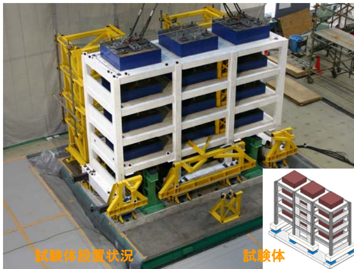
鉄筋コンクリート建物の多方向入力振動台実験
