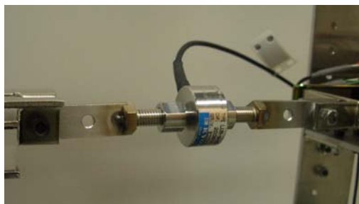
図7 共和 LUR-A-200NSA1 ロードセルと設置状況
