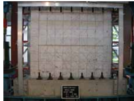
写真12 部材角 1/67(2)終了時 (試験体 BSR)
