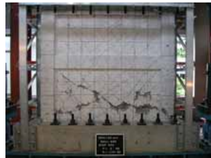
写真13 部材角 1/67(6)終了時 (試験体 BSR)
