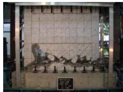
写真15 最終破壊状況 (試験体 BSR)
