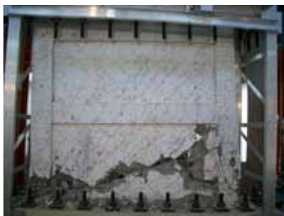
写真4 最終破壊状況 (試験体 AS)
