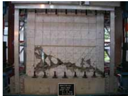
写真14 部材角 1/50(2)終了時 (試験体 BSR)
