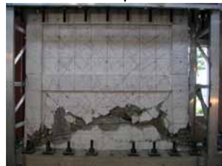
写真8 最終破壊状況 (試験体 ASR)
