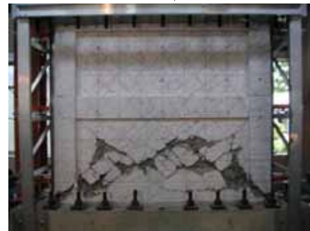
写真7 部材角 1/67(2)終了時 (試験体 ASR)
