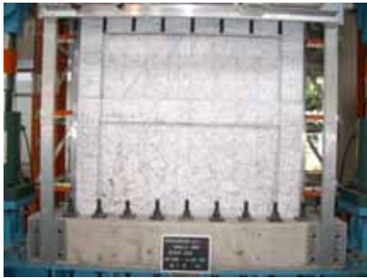
写真9 部材角 1/67(2)終了時 (試験体 BS)
