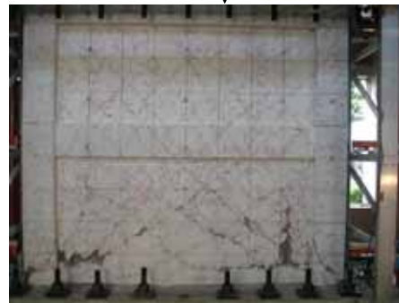
写真6 部材角 1/100(6)終了時 (試験体 ASR)
