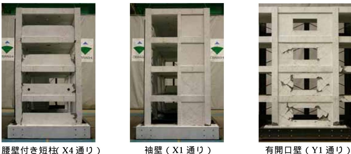
写真 3 Case2 最終破壊状況 (Run9 終了後)
