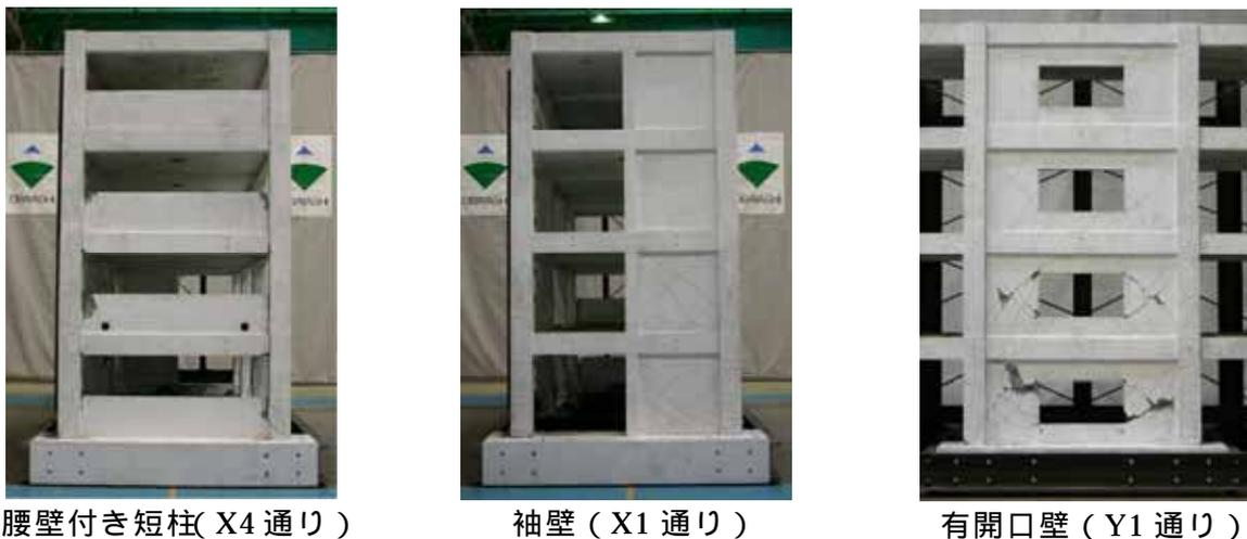
写真 2 Case1 最終破壊状況 ( Run7 終了後 )
