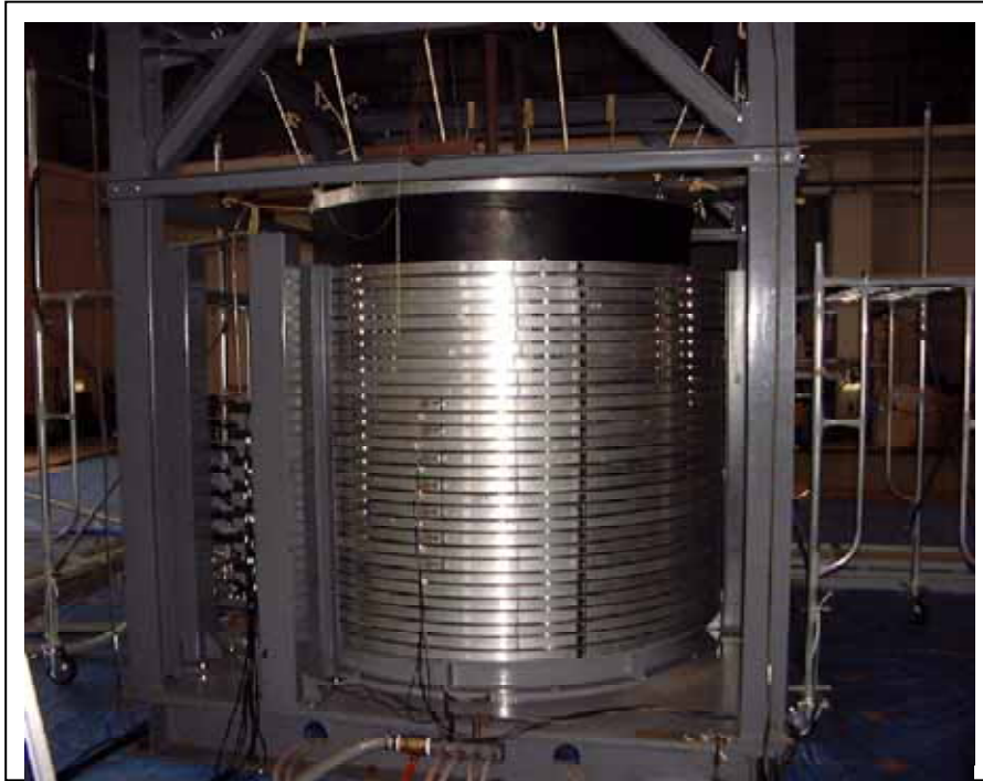
写真2 せん断土槽の外観
