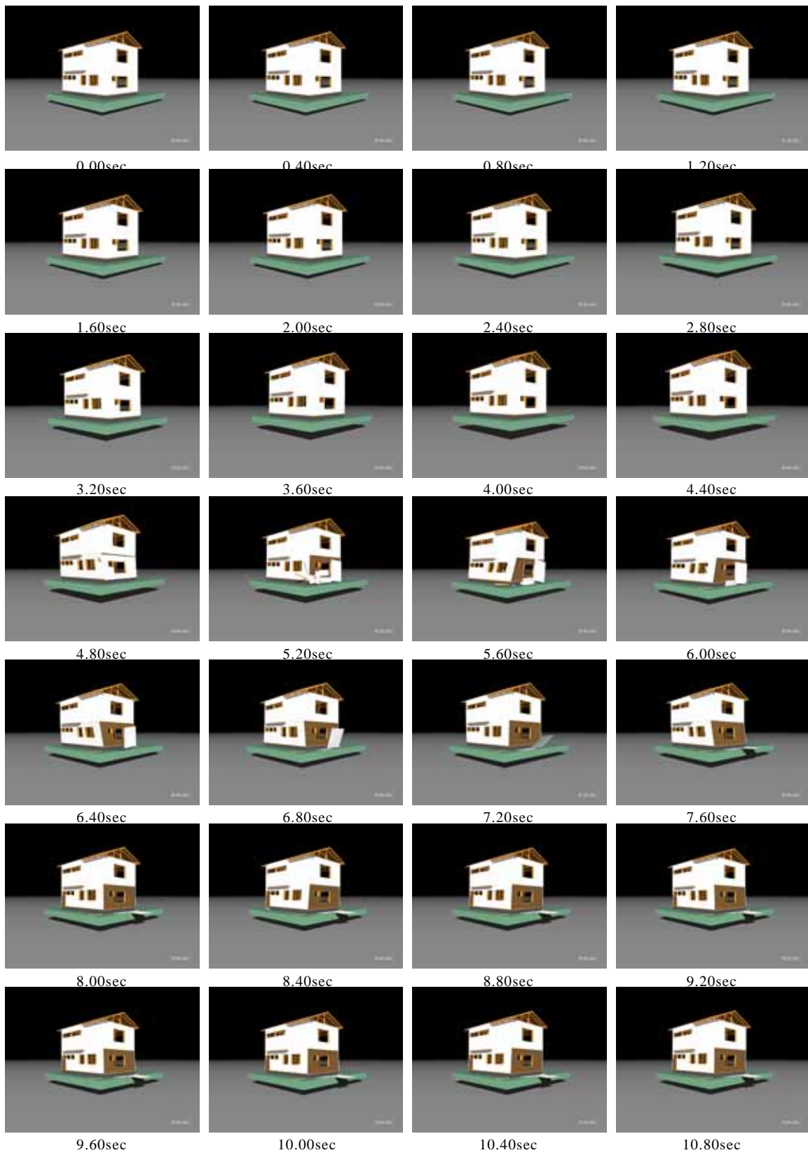
図18 解析による応答変形・倒壊過程 (川口記録 Case 2)
