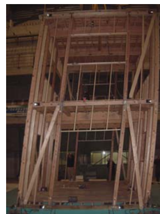
写真1 No. 4 の残留変位
