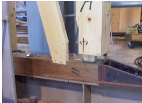
(1) 通し柱の抜け
