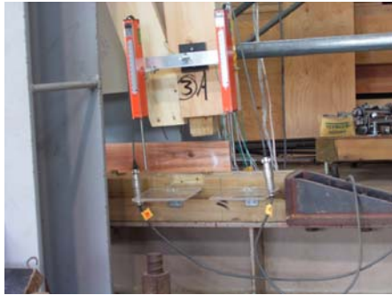
(1) 通し柱の抜け、筋かいははずれ
