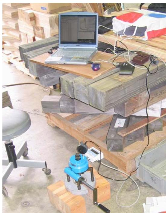
写真6 釘引き抜き試験装置
