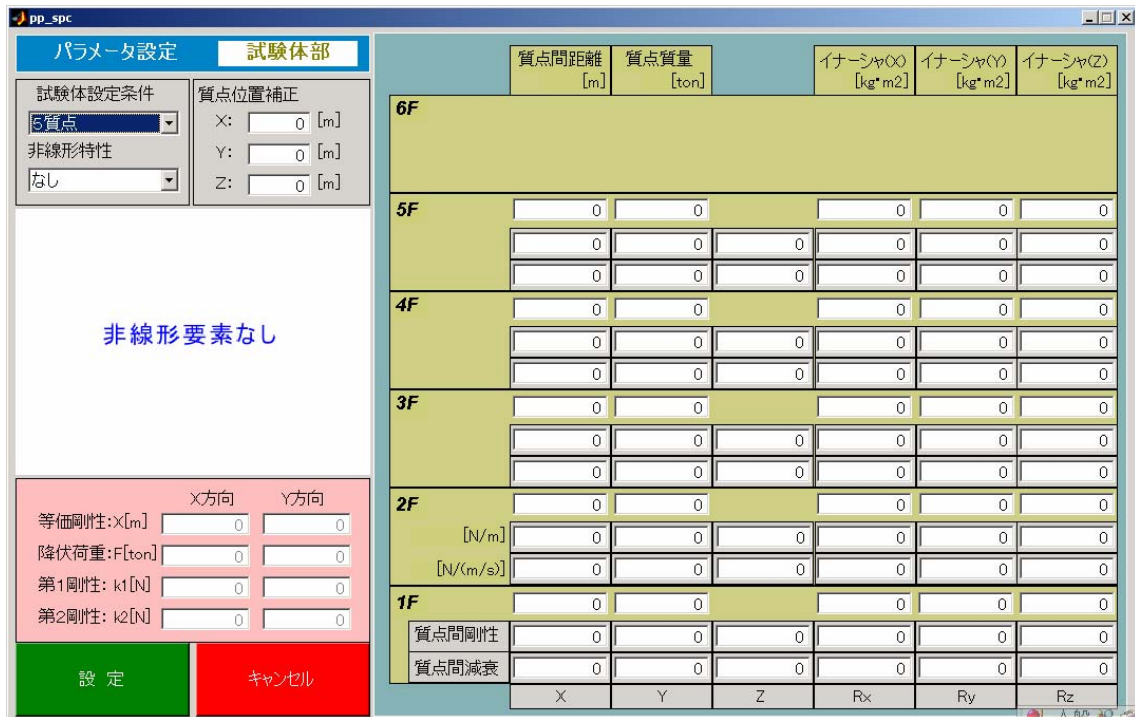
図 9(e) パラメータ設定画面の例(試験体)
