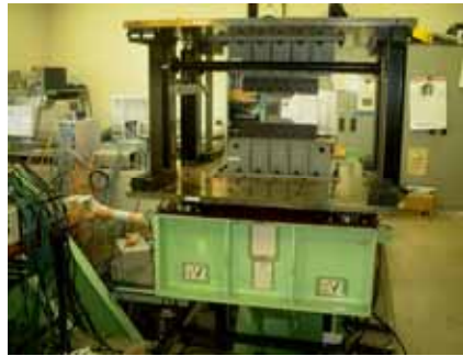
図8 小型震動台と試験体モデル
