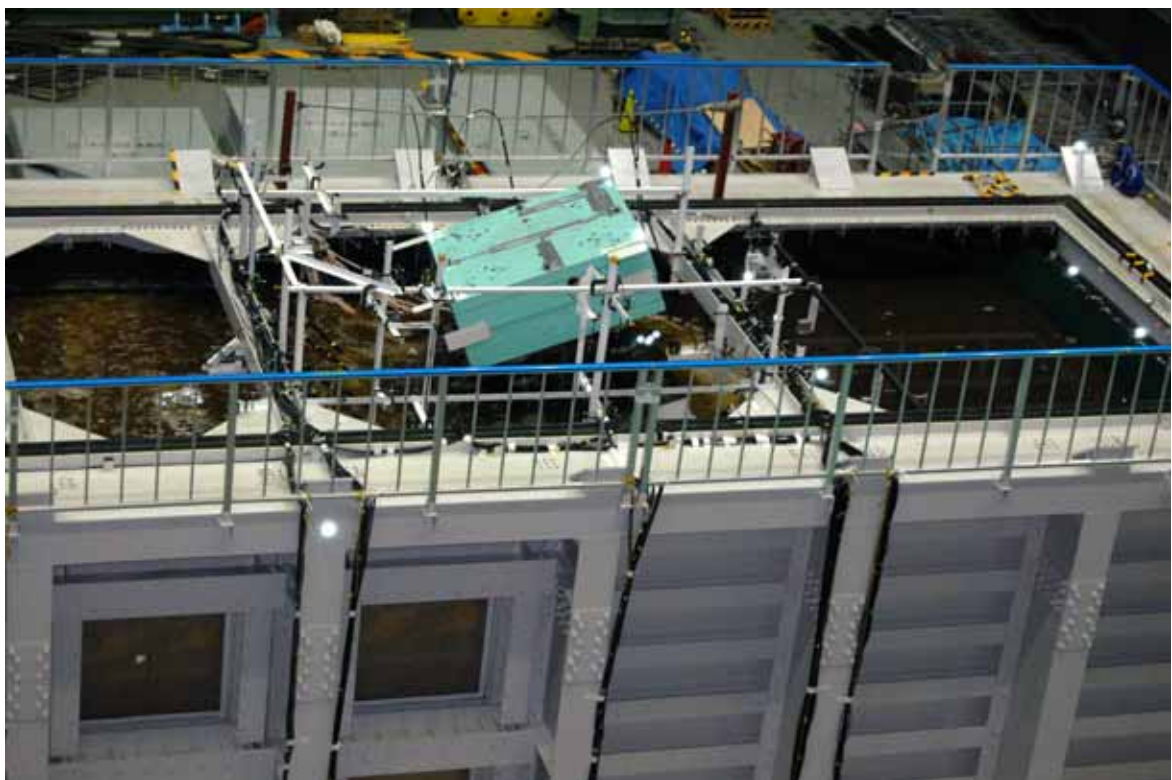
直方体剛体土槽（長さ 16m、幅 4m、高さ 4.5m）側方流動に伴う護岸とその背後杭基礎の実験
