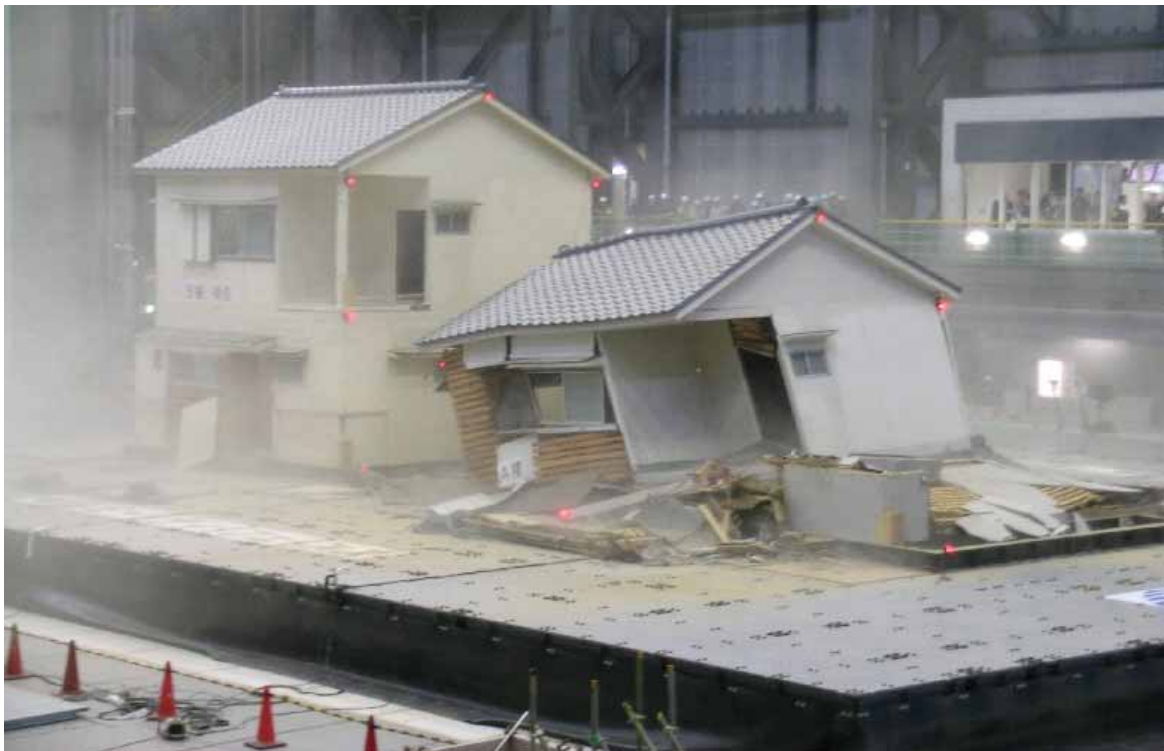
既存不適格木造建物補強(右側)・無補強(左側)実験 (築30年の一般的な2階建て木造軸組構法住宅2棟を選現地から移築し実験)
