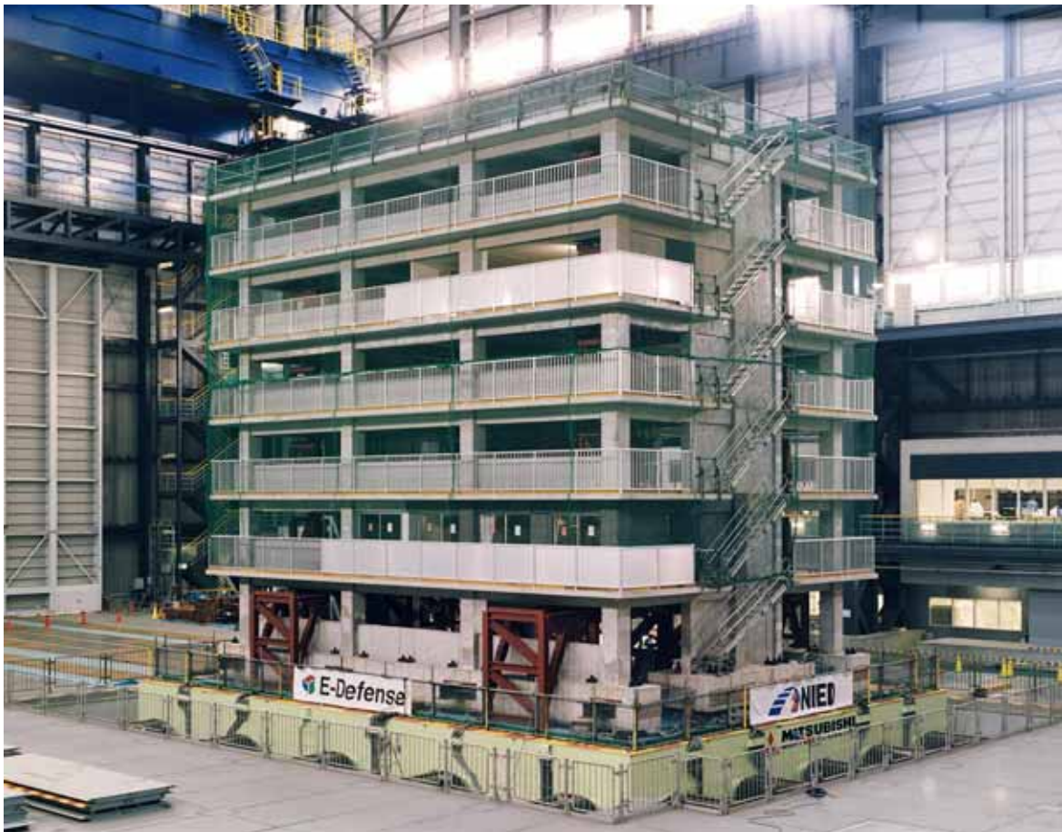
連層耐震壁を有するフレーム構造・鉄筋コンクリート建物実験 (1970年代建設を想定した設計平面:12×17m(2×3スパン)、総高さ16m、総重量約950tf)
