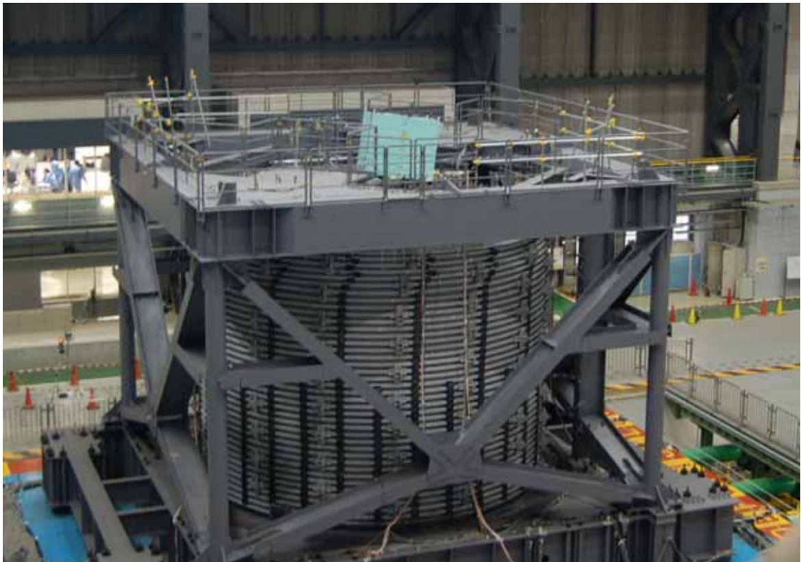
大型せん断土槽（高さ 6.5m、直径 8m）による水平地盤における杭基礎の実験
