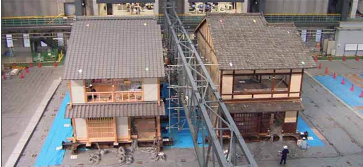
都市型の伝統構法木造住宅である京町家の実大振動実験 新築京町家試験体(左側) 移築(築70年)京町家試験体(右側)
