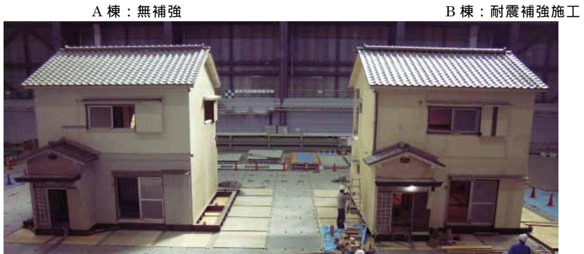
写真 38 震動台上に移築された明石 H 邸
