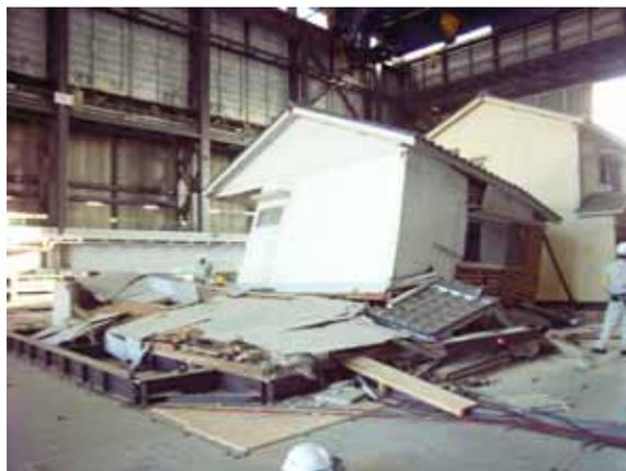
写真 42 A棟の倒壊後の状況
