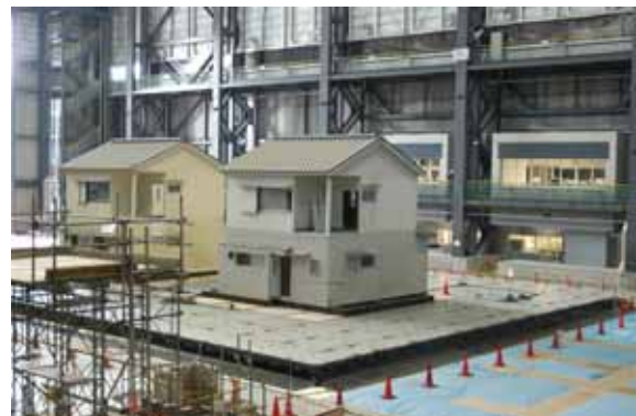
写真2 震動台実験試験体住宅 (震動台上)
