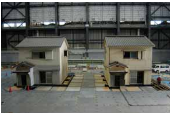
写真2 震動台実験試験体住宅 (震動台上)
