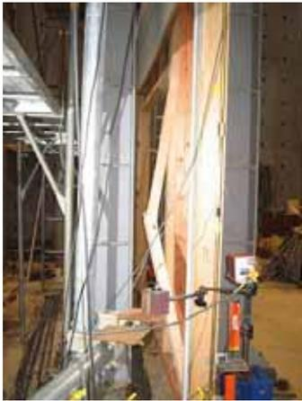
(1) E4P-R 右 筋かい座屈破壊
