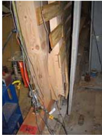
(2) E4P-R 左 筋かい端部破壊
