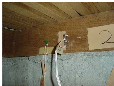
写真 6 結露センサー (左) 含水率計 (右)
