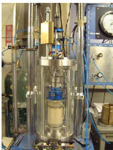
写真 2 低拘束圧用の繰返しねじりせん断試験装置のセル
