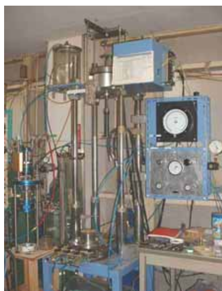
写真 3 低拘束圧用の繰返しねじりせん断試験装置の载荷部
