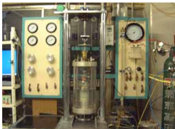
写真 1 通常の拘束圧用の繰返しねじりせん断試験装置
