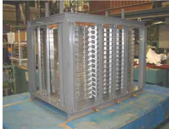
写真 6 中型振動台とせん断土槽
