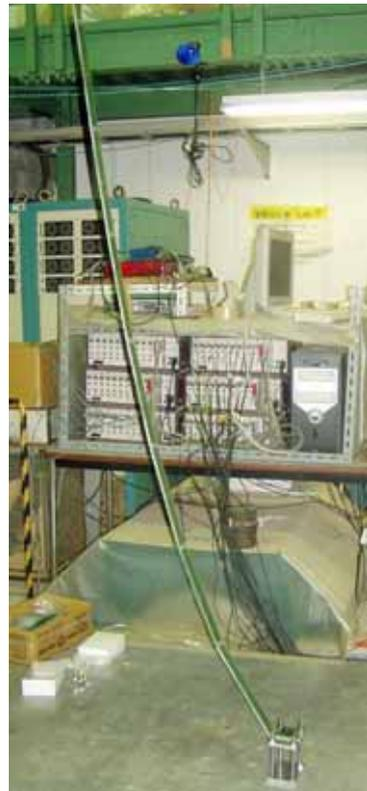
写真 3 地中変位計の組み立て例
