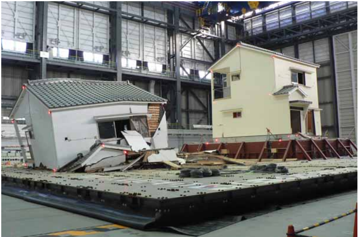
在来木造軸組建物における耐震補強比較実験（無補強(左側)・補強有り(右側)） （昨年度実施の木造住宅をと同一仕様の住宅を新築で再現）
