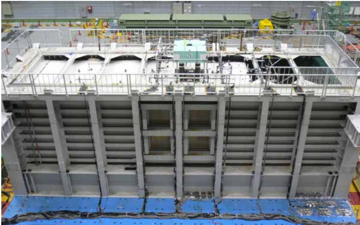
直方体剛体土槽（長さ 16m、幅 4m、高さ 4.5m）を用いた 側方流動に伴うケーソン護岸とその背後の杭基礎構造物の実験
