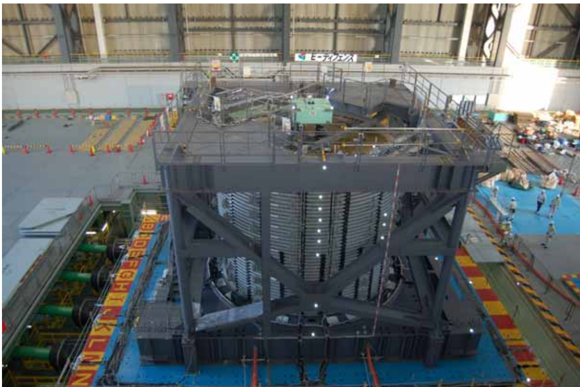
大型せん断土槽（高さ 6.5m、直径 8m）を用いた 水平液状化地盤における杭基礎構造物の実験
