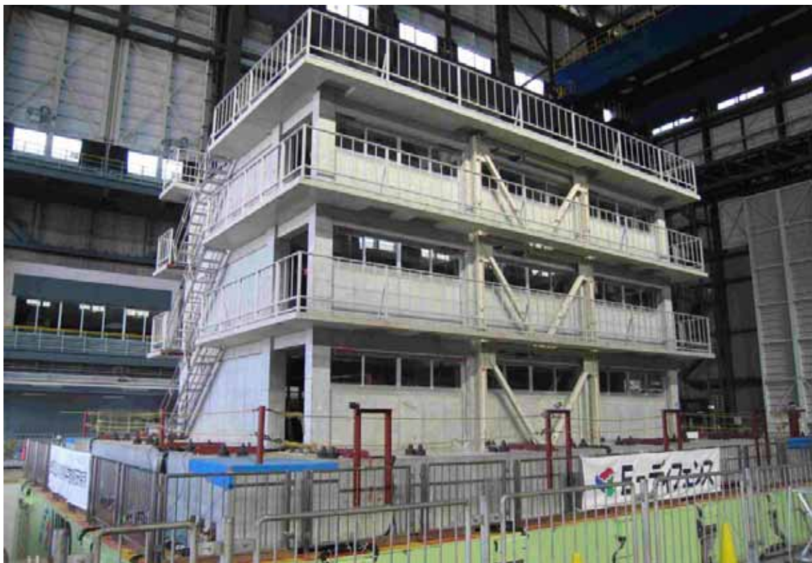
外付け鉄骨ブレース補強を施工した鉄筋コンクリート造学校校舎の震動実験
