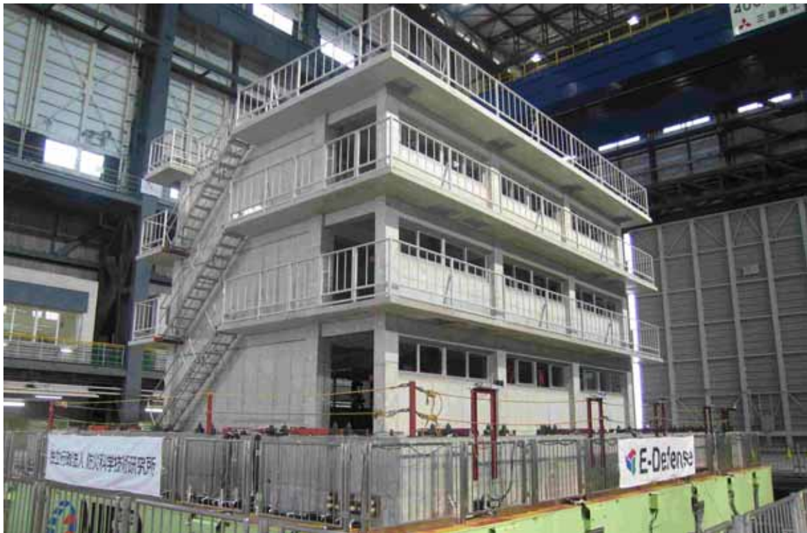
古い（1970年代）の学校校舎を模擬した RC 試験体による耐震補強比較実験（補強なし）
