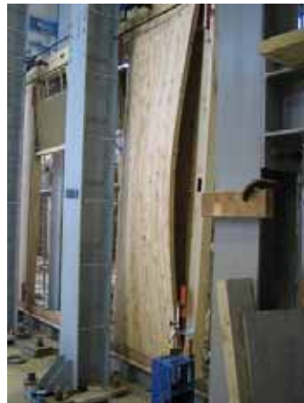
(2) I4P-R 左 受け材のはずれ
