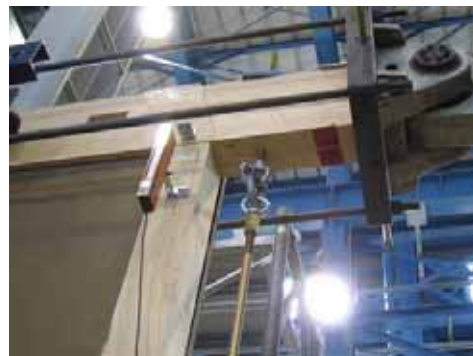
写真 2 簡易タイロッド上端部
