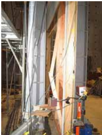
(1) E4P-R 右 筋かい座屈破壊
