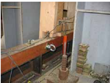
(4) N-E4P-R 左 柱引き抜け
