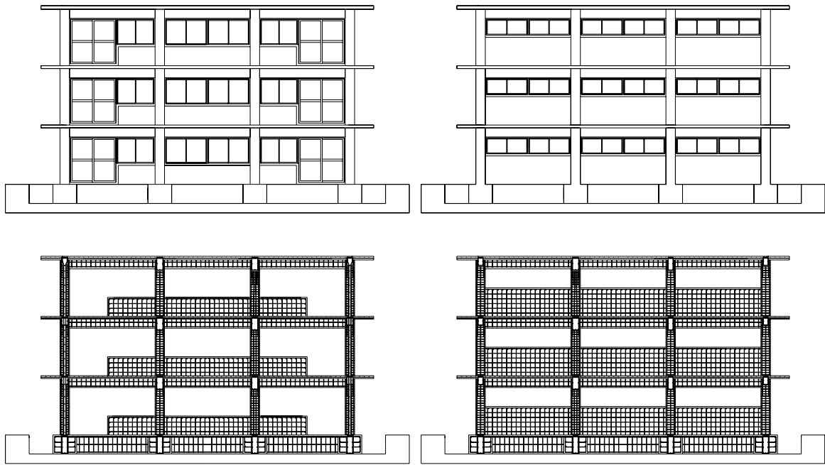
図8 仕上げ図および配筋図
