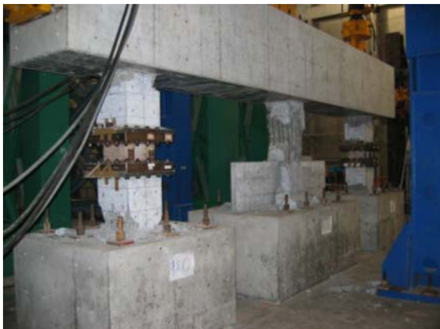
図 3 1 加力試験後 試験体状況
