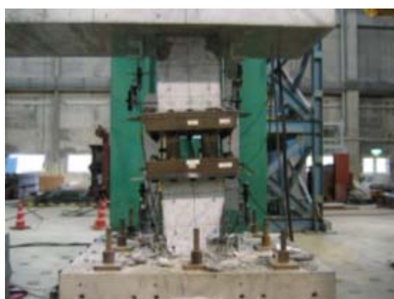
図 3 2 柱 A（曲げ先行型靱性小柱）破壊状況
