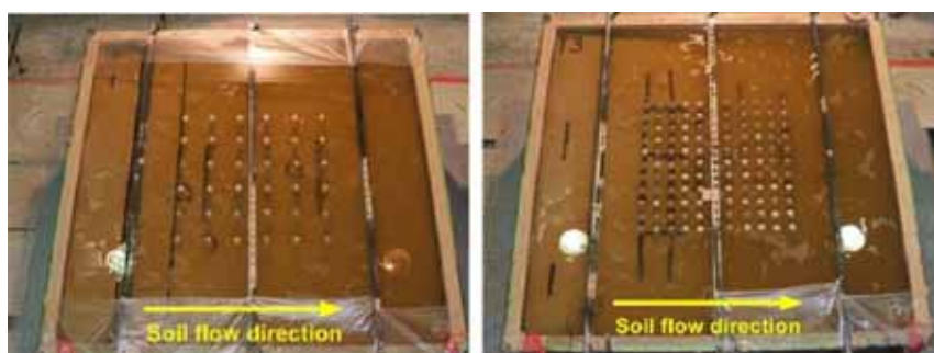
(a) Test1 : 群杭 (6 x 6) (b) Test2 : 群杭 (11 x 11)
