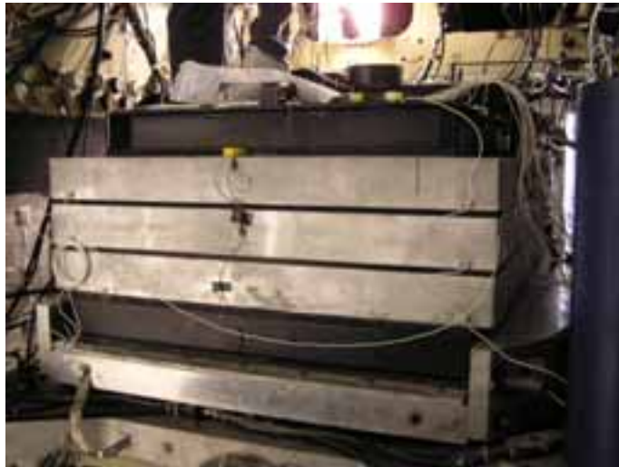
写真5 実験で用いたせん断土槽
