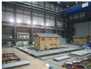
写真2 震動台上の試験体
