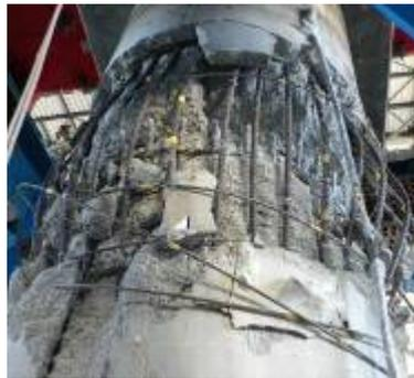
(b) 橋脚上部段落し部 破壊部
