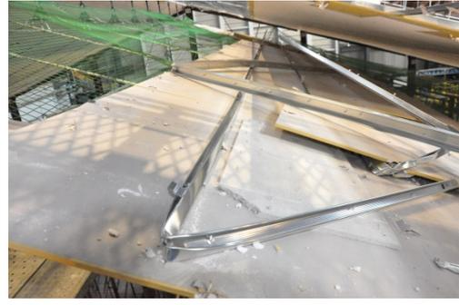
一方、耐震天井の実験では、天井脱落の生じた K-NET 仙台波 50%(震度 6 弱)では、1.1G 耐震天井、2.2G 耐震天井ともに損傷はありませんでした。K-NET 仙台波 80%および 100% (いずれも震度 6 強相当) の実験では、天井面が大きく振動し、1.1G 耐震天井では、斜め部材 (ブレース) が曲がり始めたものの、脱落に至ることはありませんでした。さらに、兵庫県南部地震の記録を 1.5 倍にまで増幅させた揺れ (震度 7 相当) で実験した結果、耐震天井も大きく揺さぶられ、ブレースが外れ、天井面を構成する骨組みが変形し、天井ボードが大きく脱落しました。
