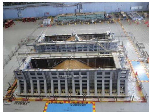
写真-1 土槽設置状況
