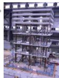
長周期地震動に対する、居住空間の安全性と建造物の耐震性能については、未解明な部分が多いです。そのため、住空間の安全性については、平成20年1月に行われた兵庫県との共同研究で、一般的な30階高層建物について実験を行い、建造物の耐震性能については、文部科学省からの委託研究「首都直下地震防災・減災特別プロジェクト」の一環として地上21階高さ80mの鋼構造建物を想定し、同年3月に実験を行っています。兵庫県との実験では、高層建物を部分的に切り出した実大寸法の試験体とし、250秒以上に及ぶ長周期地震動による大振幅応答を再現するため、試験体の基部に、積層ゴムを介した振動増幅層を設置しました。文科省委託研究では、1階から4階までの構造を実規模で、5階以上の高層階は積層ゴムとコンクリートスラブによる縮約モデルを3層とした試験体としました。
