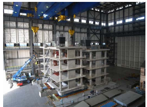
試験棟内に運び込まれ振動台に載せる
