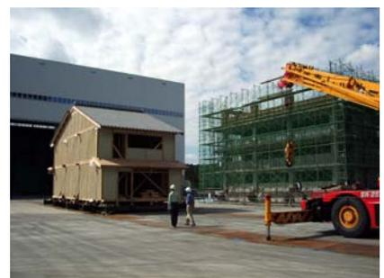
前号でお知らせしたとおり、この試験では、試験体の準備を主に実験準備棟で行った後、実験棟に移動し、震動台上に搭載して加振試験を行います。10月12～13日の2日にかけて、これまで数ヶ月にわたり作成してきた京町家実験で使用する試験体を実験棟に移動しました（写真）。また、兵庫県明石市から移築した試験体は、現在実験準備棟内で再組立中です。現在は、このような実験直前の試験準備中ですが、本号が刊行される頃には、最初に行う免震住宅の加振が始まっていると思います。これまで多くの方々の多大なご尽力により、試験実施まで進んできました。この1ヶ月半の実験ではE-ディフェンスの性能を十分に活かし、有用な成果が得られるよう努力したいと思います。
