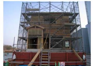
写真 2 模擬地盤上に建てられた試験体
