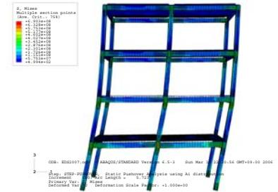
図3 4階建て鉄骨建築の実大震動・崩壊実験の解析結果(変位図)
