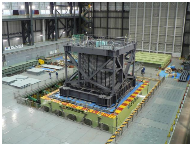
写真1：震動台上に設置された試験体
