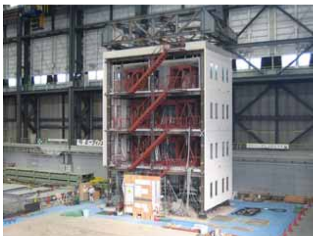
E-ディフェンス実験棟内で建設中の鉄骨造建物試験体
