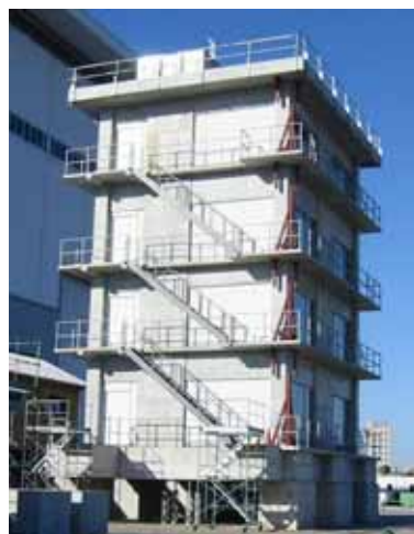
図 2 病院を模擬した試験体
