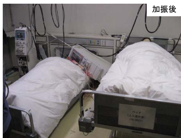
人工透析室 (キャスターをロックした人工透析機が転倒)
