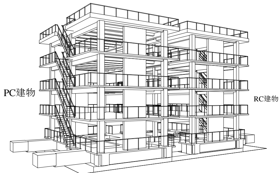
図3 振動台上の外観 (ビデオ映像のパース)
