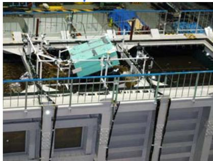
地盤の側方流動により海側へ1m以上動いた矢板護岸とその背後の構造物
