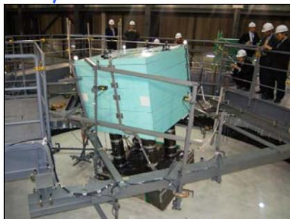
大きな3次元加振により傾いた上部構造物
