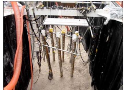
地盤内で折れ曲がった杭(地盤撤去後の様子)
