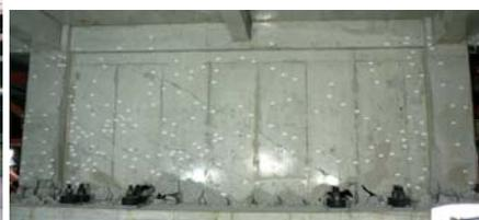
1層耐震壁の損傷状況
