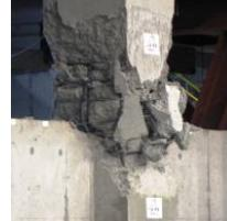
1層の壁腰付き短柱の破壊状況
